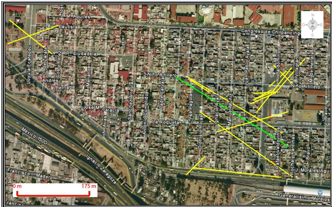
Figura 3.22. Imagen que muestra las fracturas representadas en una imagen de Google Earth, en la colonia Popular Ermita Zaragoza.
