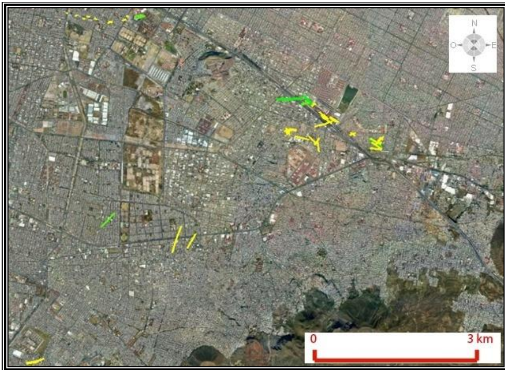
Figura 5.32. Imagen que muestra la totalidad de los datos estructurales recolectados en la Zona Centro Oriente. Las líneas en color amarillo y verde corresponden con fracturas y con fallas respectivamente.
