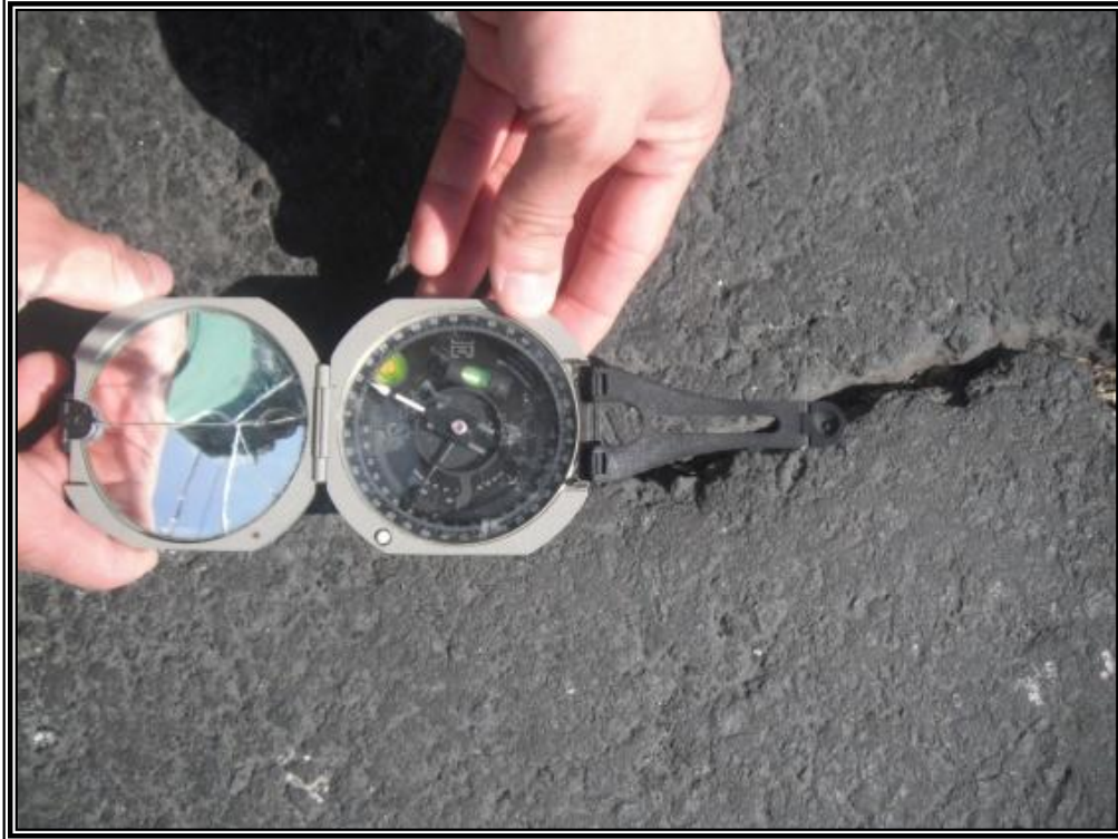
Figura 1.4.5. Toma de rumbo de fractura en el pavimento de Av. México, Xochimilco D.F.
