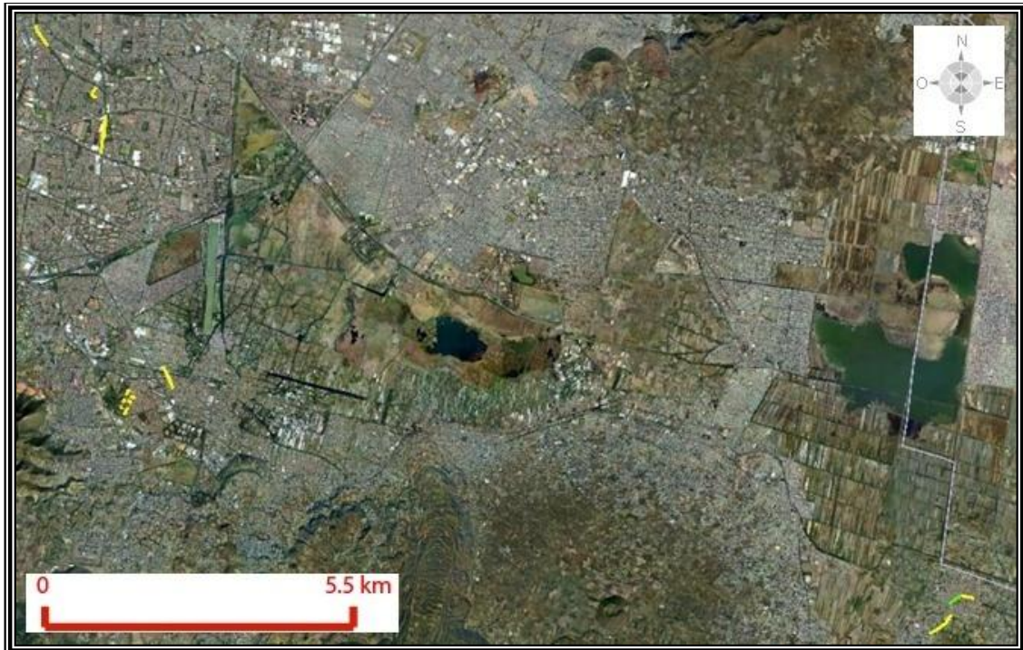
Figura 5.34. Imagen que muestra la totalidad de los datos estructurales recolectados en la Zona Sur. Las líneas en color amarillo y verde corresponden con fracturas y con fallas respectivamente.
