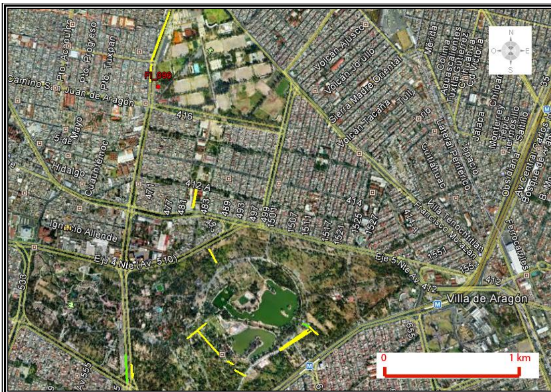
Figura 5.16. Ubicación de las fracturas y fallas en color amarillo y verde respectivamente. Los pozos de extracción de agua corresponden con los puntos en color rojo.
