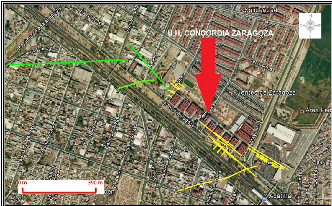
Figura 4.1. Ubicación de las fracturas y fallas representadas en una imagen de Google Earth, en la Unidad Concordia Zaragoza. Las líneas amarillas corresponden con fracturas y las verdes con fallas.
