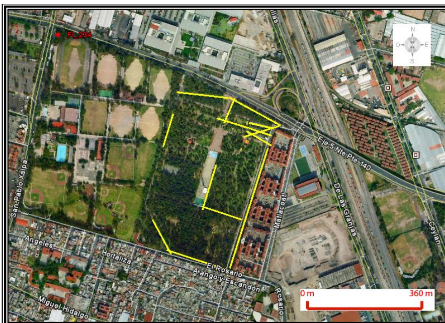
Figura 4.47. Ubicación de las fracturas representadas en una imagen de Google Earth, en la Alameda Norte.
