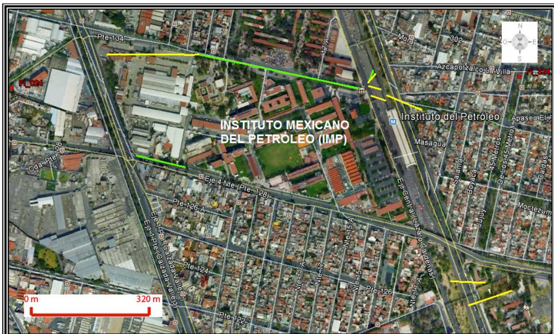
Figura 4.27. Ubicación de las fracturas y fallas representadas en una imagen de Google Earth, en las inmediaciones del IMP. Las líneas amarillas corresponden con fracturas y las verdes con fallas.
