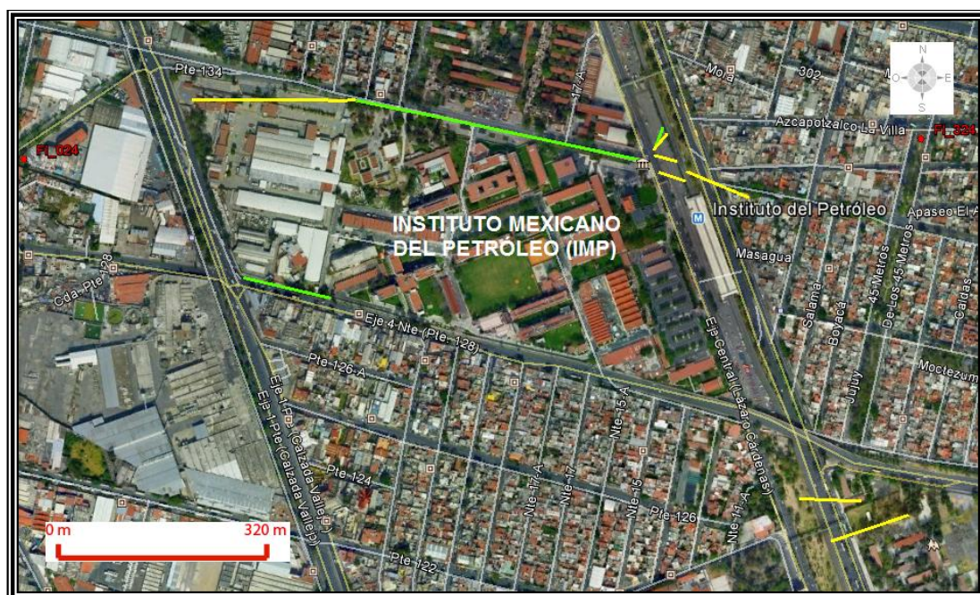
Figura 3.61. Imagen que muestra las fracturas representadas en una imagen de Google Earth, en las inmediaciones del IMP, en la colonia Nueva Vallejo.
