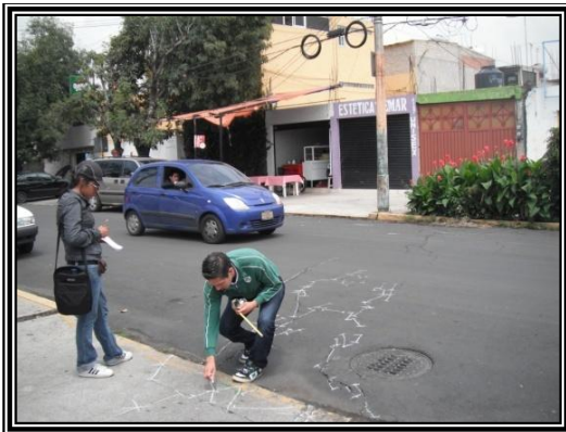
Figura 1.4.3. a) Marcado con gis de las fracturas; b) Acercamiento para ver detalles de las fracturas marcadas en Xochimilco.
