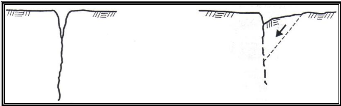
Figura 3.5. Fractura aislada, antes (izq.) y después (der.) de lluvia o de un sismo (Romero, 2011).
