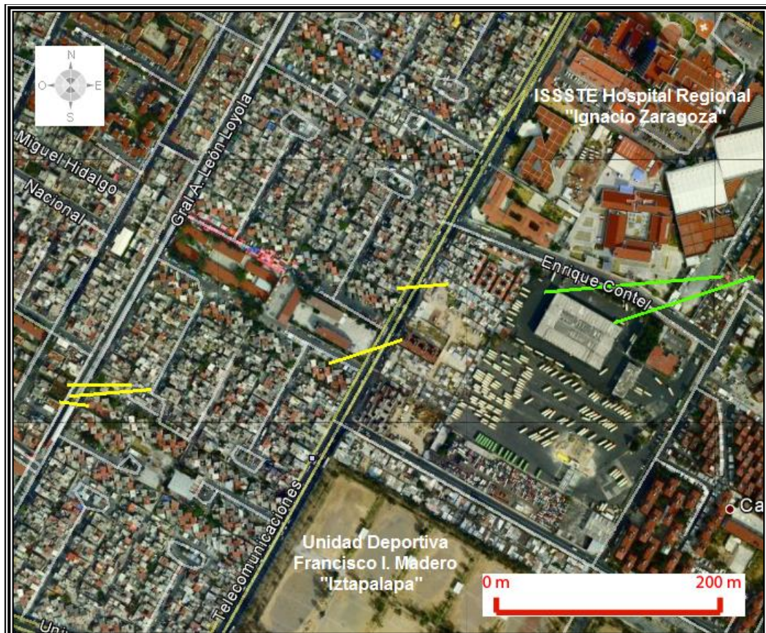
Figura 3.39. Imagen que muestra las fracturas y las fallas, en color amarillo y verde respectivamente, representadas en una imagen de Google Earth, en la Colonia Guelatao de Juárez.
