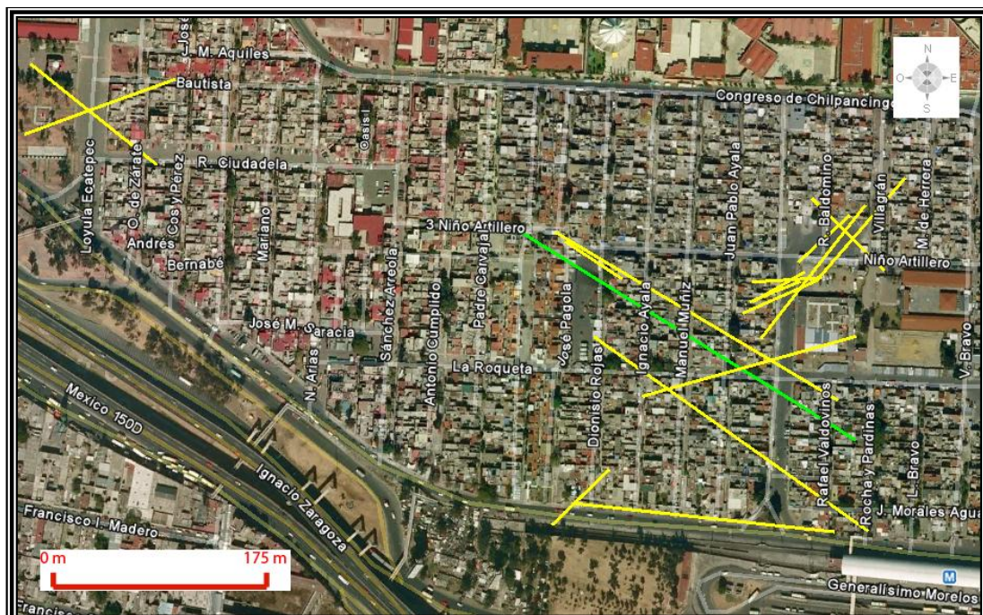
Figura 4.3. Ubicación de las fracturas y fallas representadas en una imagen de Google Earth, en la colonia P. Ermita Zaragoza. Las líneas amarillas corresponden con fracturas y las verdes con fallas.
