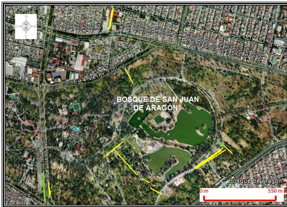
Figura 4.23. Ubicación de las fracturas y fallas representadas en una imagen de Google Earth, en el Bosque de Aragón. Las líneas amarillas corresponden con fracturas y las verdes con fallas.
