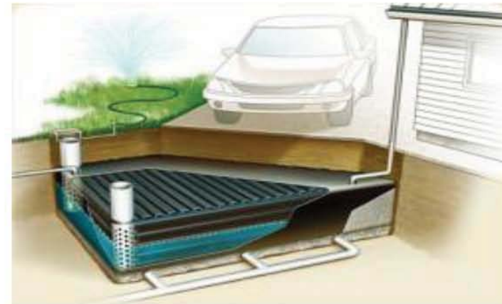
Imagen 17.- Almacenamiento de agua de lluvia
