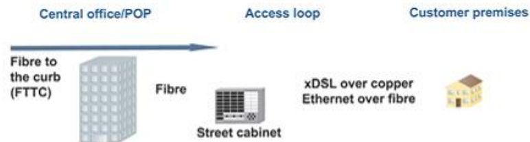
Figura 4.28 Fibra Hasta La Acera (FTTC) [26]
