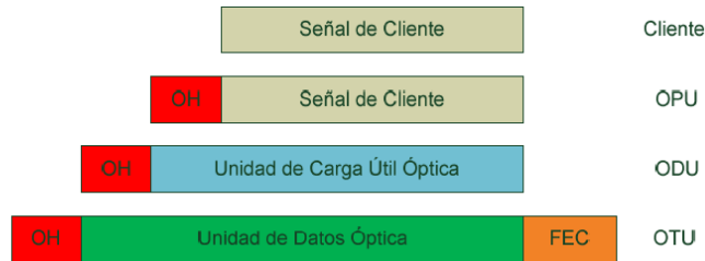
Figura 3.19 Encapsulamiento de la señal cliente, Parte I [15]
