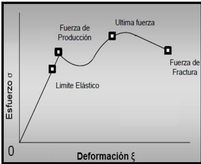
Figura II.2 Comportamiento del acero bajo cargas, al sobrepasar el límite elástico, el modelo deja de ser lineal puesto que existe una deformación en el material.
