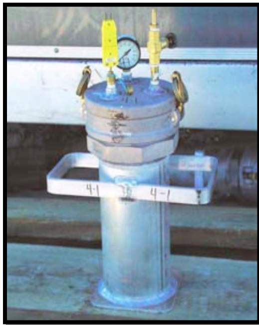
Figura I.15 Canister, aparato utilizado para contener las muestras de núcleos (laboratorios Weatherford).
