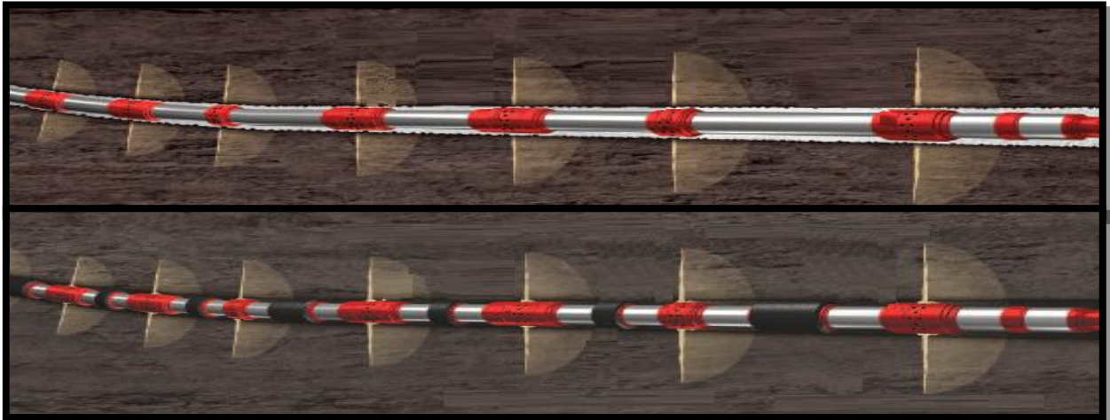
Figura II.10 Muestra la técnica de terminación con camisas deslizables, aislando zonas con ayuda de empacadores, esto es posible gracias a los avances tecnológicos, cabe mencionar que el proceso requiere del uso de tubería flexible.
