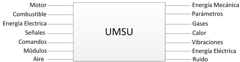
Figura 4.1: El sistema UMSU se puede apreciar como una caja negra donde el equipo de desarrollo expresa todas las entradas y salidas del sistema.
