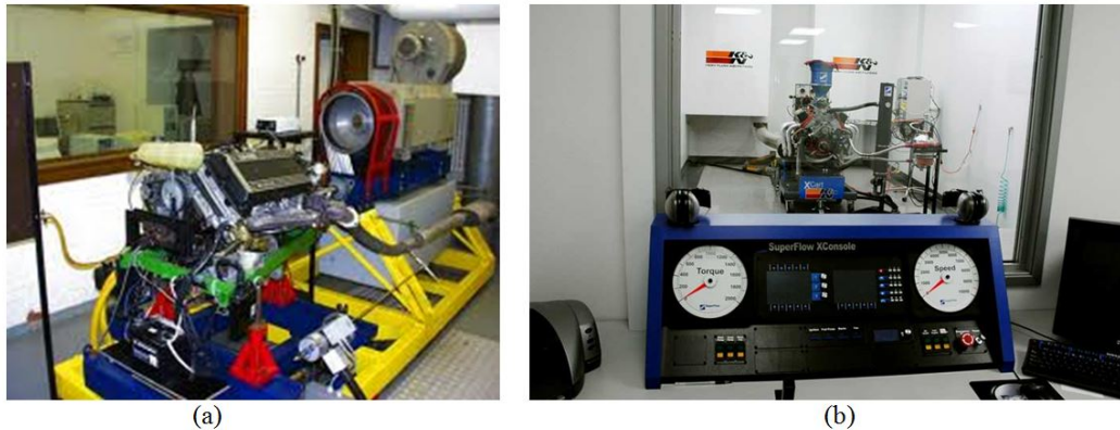
Figura 1: Banco de pruebas con los respectivos sistemas para funcionamiento del motor (a) [24]. Consola de instrumentos de medición (b). [19]
