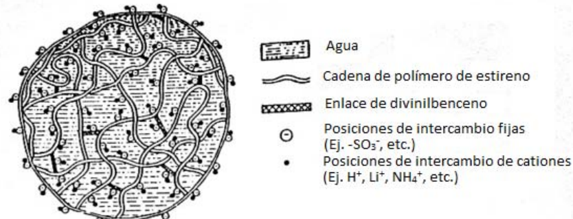
Figura III-2. Diagrama esquemático de una resina de intercambio iónico catiónica - ácido fuerte.
