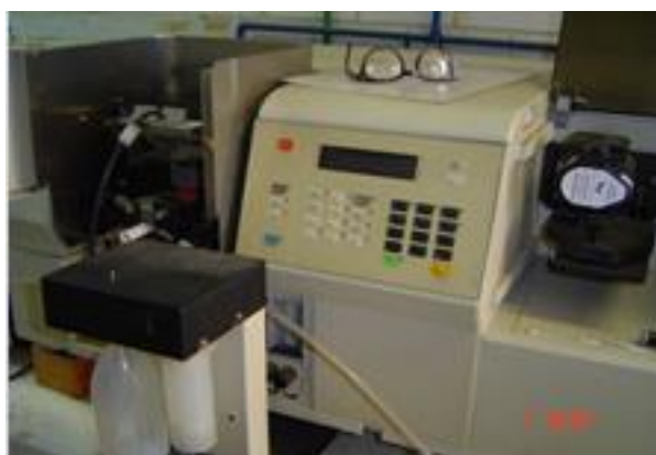
Figura 3.6. Espectrofotómetro de Absorción Atómica empleado para el análisis.
