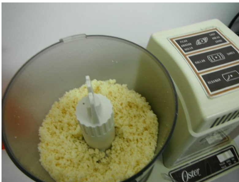
Figura 5. Reducción de tamaño de partícula de las unidades de ensayo.
