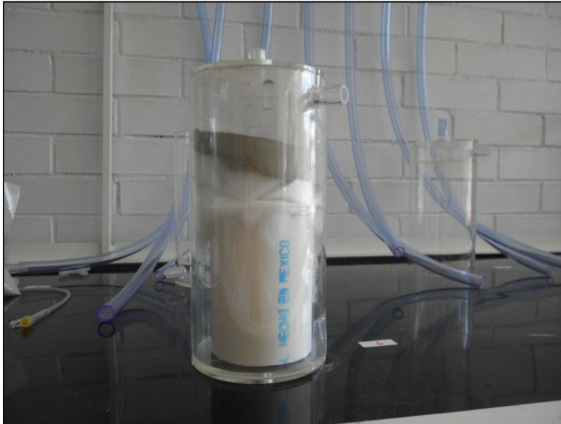
Figura 4.4 Fotografía de celda de humedad armada.
