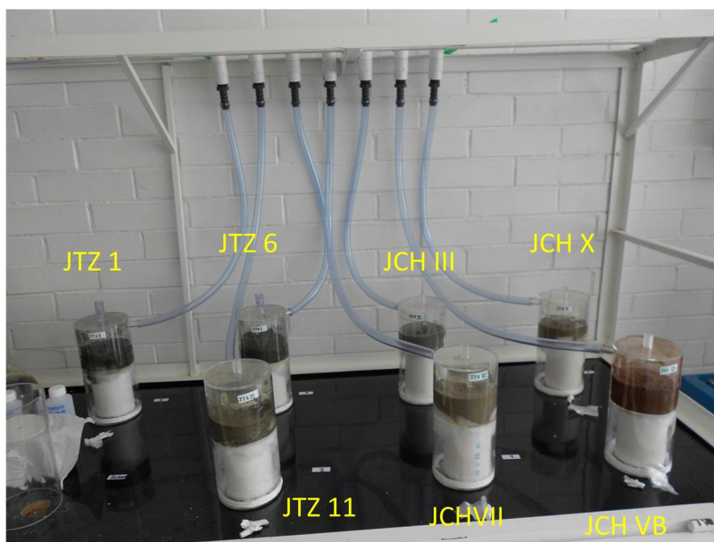
Figura 4.6 Sistema de celdas de humedad armado con las muestras de jales de Charcas y Tizapa.
