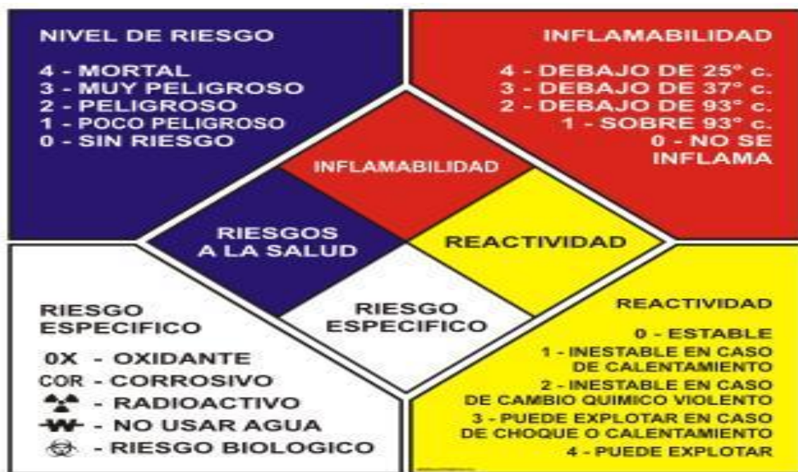
Figura 69. Rombo de señalización de Riesgos.
