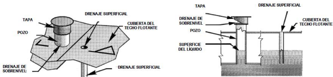
Figura 24. Drenajes de la Cubierta.
