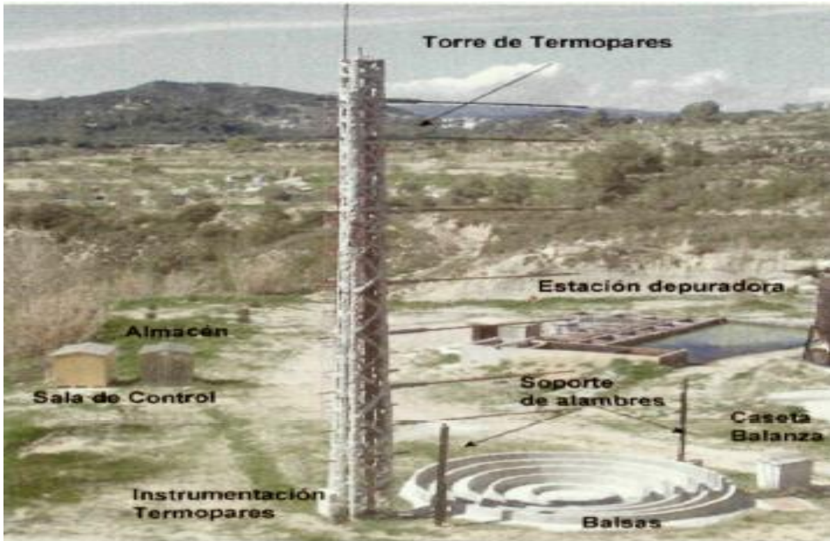
Figura 59. Instalación Experimental del CERTEC.
