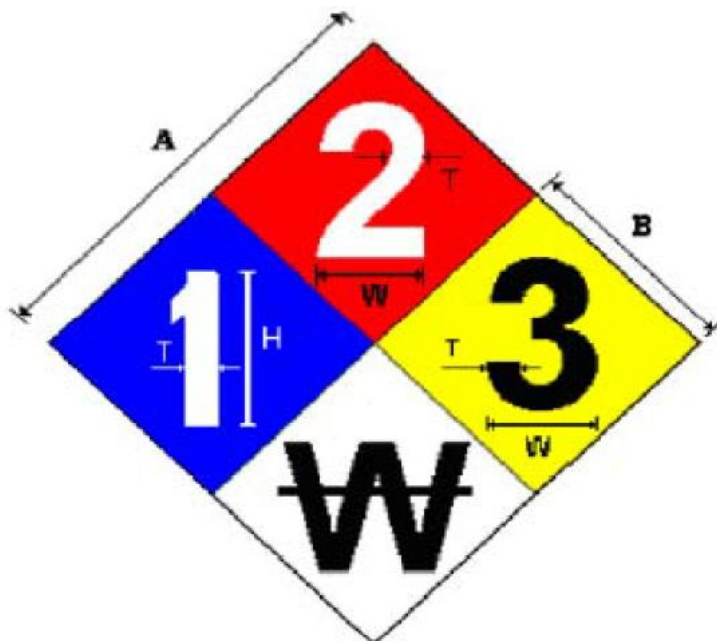
Figura 70. Dimensiones Rombo de Identificación de Riesgos.
