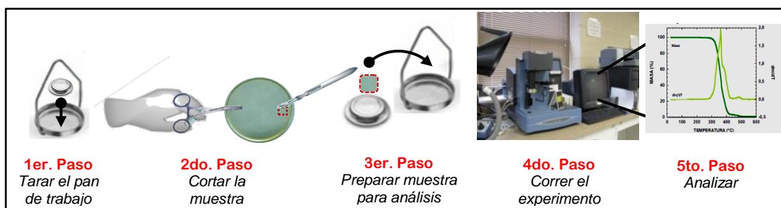
Figura 2g. Esquema que muestra la metodología de experimentación en TGA.
