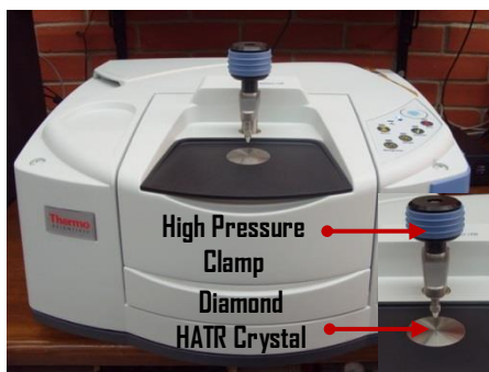
Figura 1c. Equipo Thermo Scientific Nicolet iS10 configurado con una prensa de alta presión para obtener un mayor contacto entre la muestra y el cristal HATR de diamante
