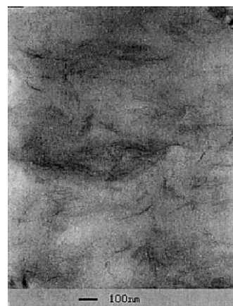
Figura 3.13 Imagen de TEM de arcilla exfoliada-intercalada en una matriz de PEA con 95/5 (g/g) PEA/Arcilla. [44]
