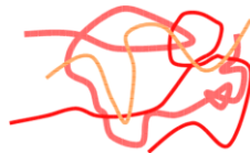
Figura 5.13 Representación esquemática de un polímero fundido en ausencia de cizallas. [55]
