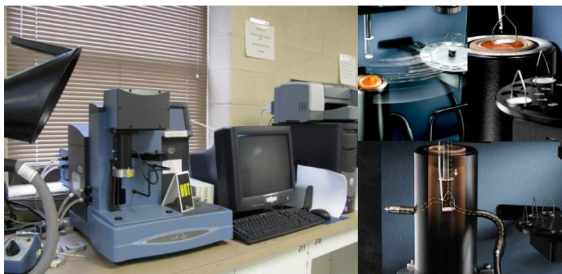
Figura 1g. Equipo Thermo Gravimetric Analysis (TGA) TA Instruments Q series-Q500-0507 con el que cuentan en el Coatings Research Institute, denominado (por sus siglas en Ingles), CRI. En la Eastern Michigan University.
