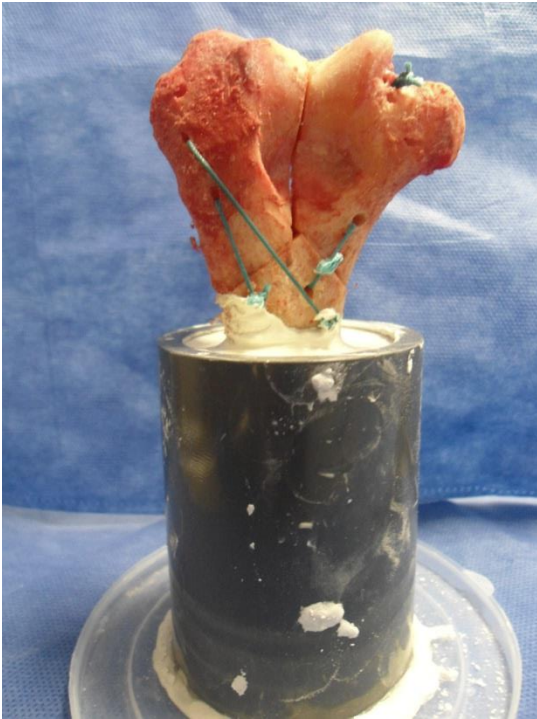
Figura 8. A la izquierda, extremo distal del húmero montado en un cilindro de policloruro de vinilo bajo fijación con cemento blanco. Arriba, montaje final previo a la aplicación de prueba de tensión o de inclinación posteroanterior.
