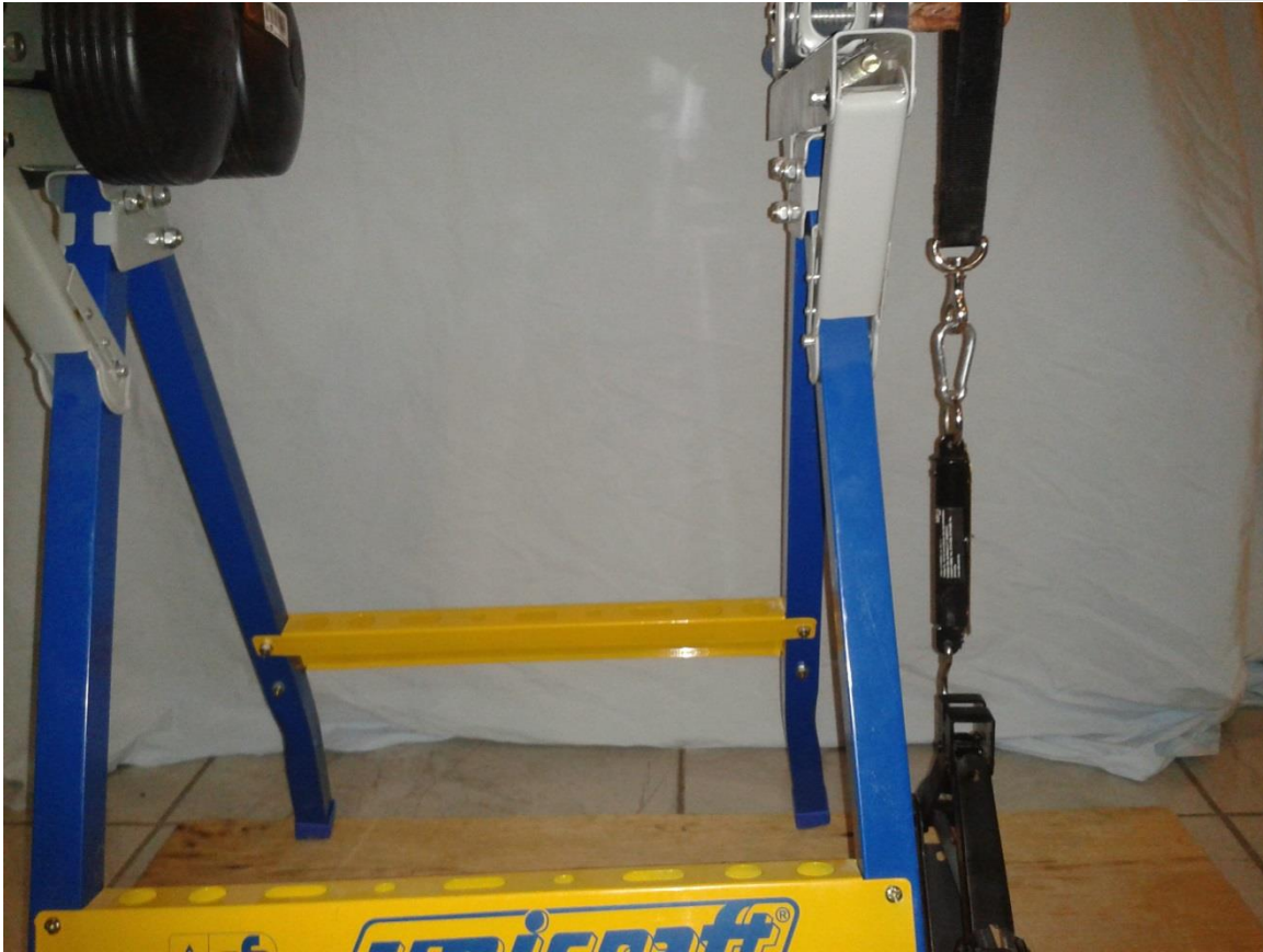
Figura 2. Se observa la mesa de tensión formada por la mesa de sostén de hueso sintético, el gato mecánico, el dinamómetro graduado de 25 kg y una correa de tensión que soporta una capacidad de 40 kg de peso.
