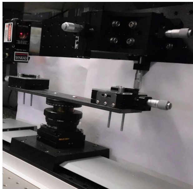
Figura 22. Sistema mecánico del láser de CO 2 .
