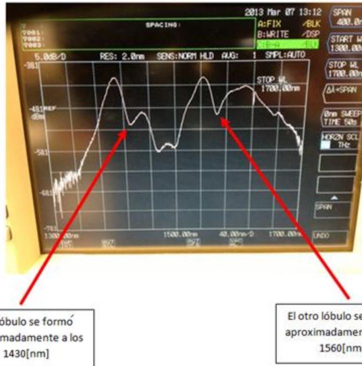
Figura 36. Espectro con los lóbulos que se comienzan a formar cuando se tiran los pulsos.
