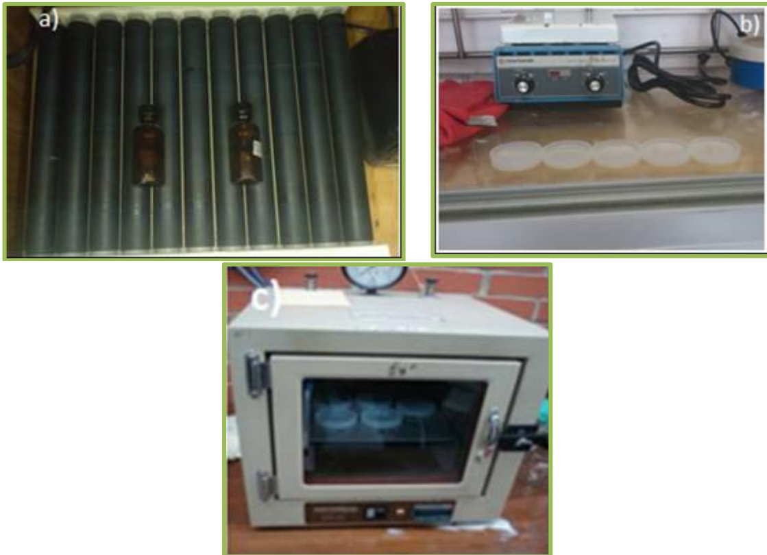
Figura 4.5. a) Rodillos de agitación. b) Campana de extracción. c) Estufa de vacío.
