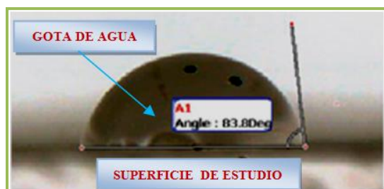
Figura 3.22. Ángulo de contacto formado por una gota de agua sobre una membrana electrohilada de nailon [109] .
