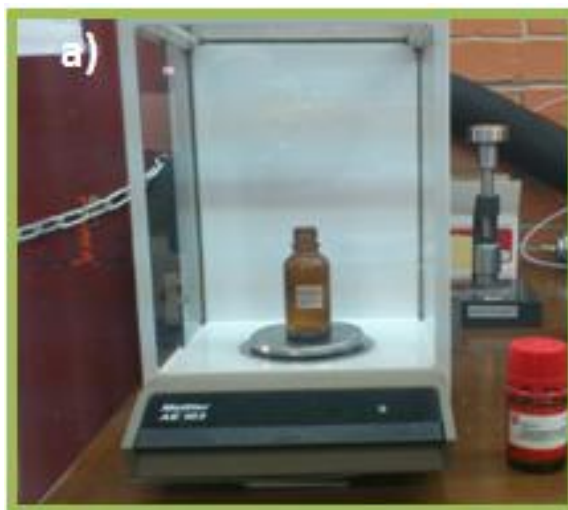
Figura 4.4. a) Proceso de pesaje de cada uno de los componentes para las películas POSS – Acrílico. b) Viales ámbar conteniendo a la nanopartícula y al poliacrílico en su concentración correspondiente.
