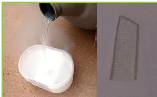
Figura 4.41. Fractura de las probetas con nitrógeno líquido para su análisis en el Microscopio Electrónico de Barrido.
