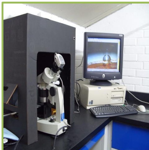
Figura 4.30. Dispositivo para medir ángulo de contacto. Diseñado y construido en el Laboratorio de Nanopolímeros y Coloides (ICF-UNAM), Castillo-Pérez & Romo-Uribe (2012)
