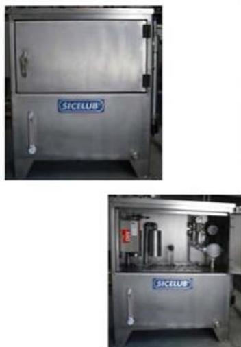
**Figura 4.32. Recolector de condensados**
