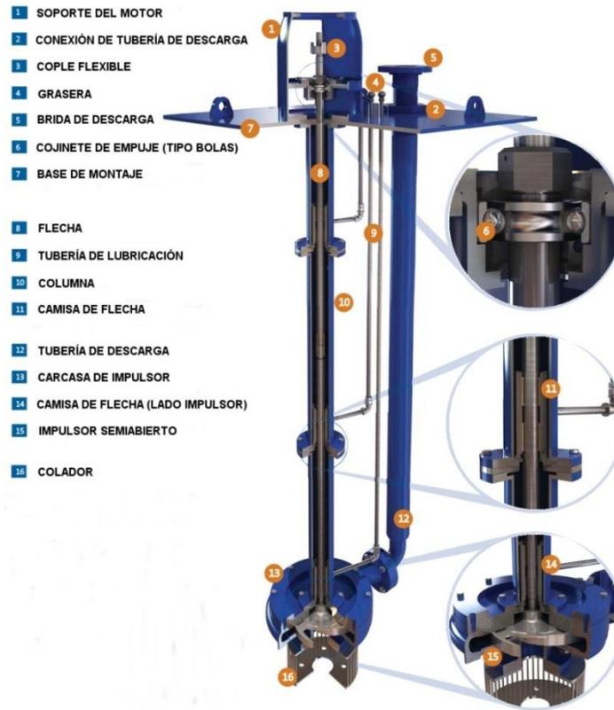
*Figura 3.21. Bomba VS4 modelo VSP de la compañía Ruhrpumpen*
