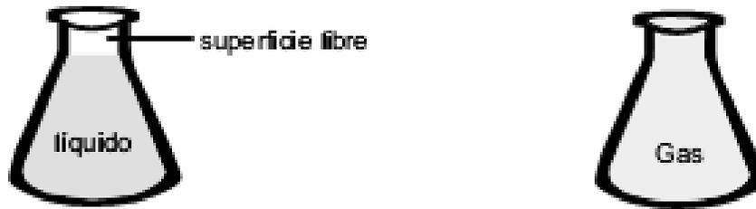
**Figura 1.1. Comportamiento de un fluido dentro de un recipiente.**
