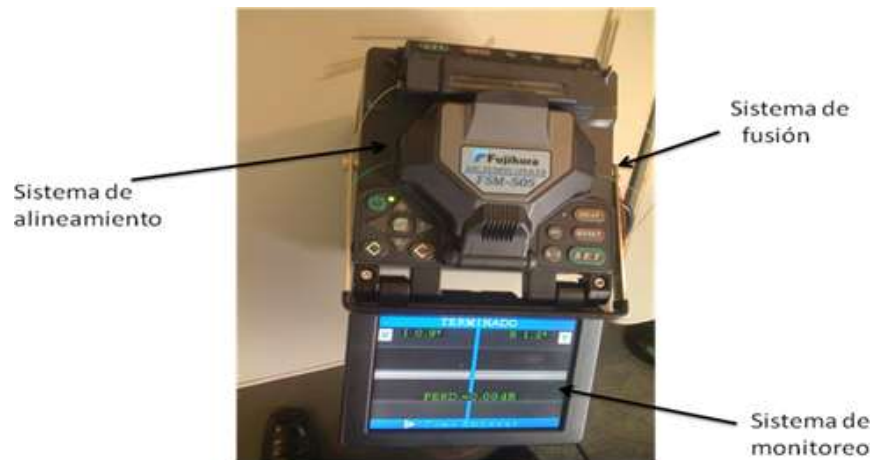
3.12. Sistemas de una Empalmadora
