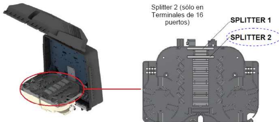
Figura 3.6. Ubicación de Divisores Ópticos en Terminal GIKO.
