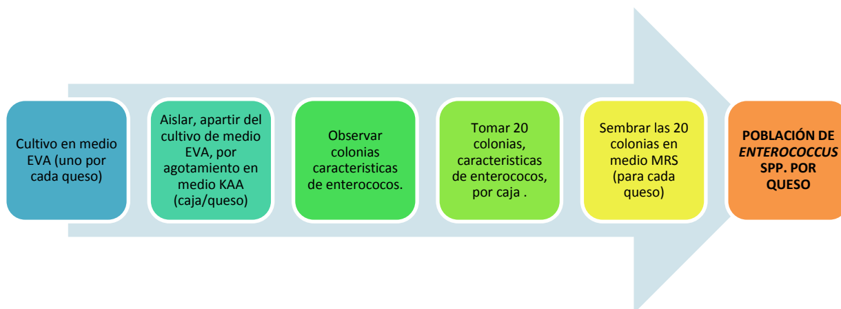
Figura 9. Diagrama de obtención de poblaciones de enterococos por cada muestra de queso Cotija
