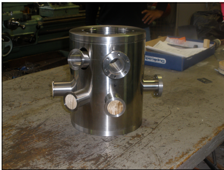
Figura 4.7: Cámara de vacío durante el proceso de construcción.
