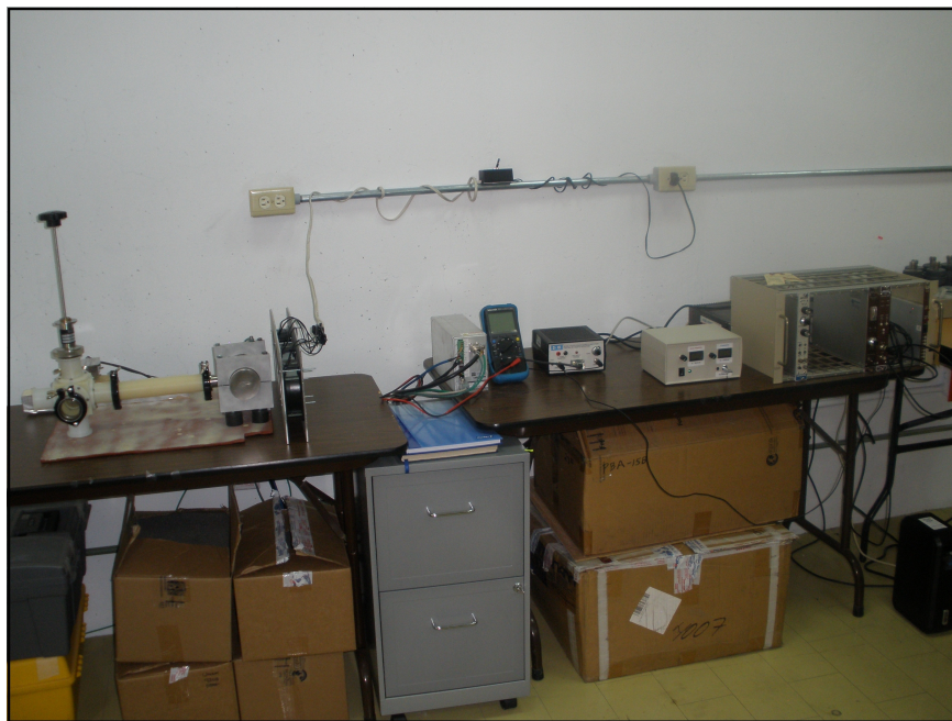
Figura 4.6: Imagen que muestra el EDS empleando tubos rayos X y la correspondiente electrónica nuclear.
