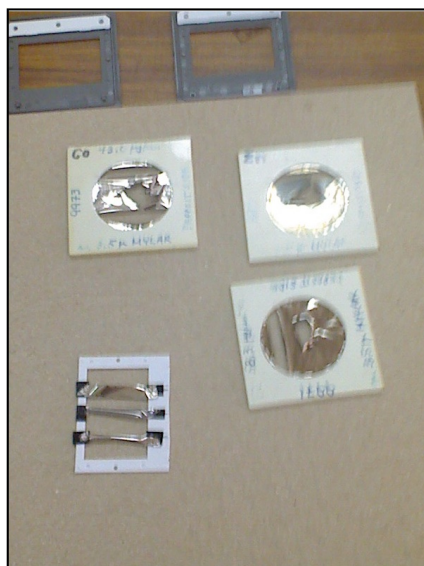
Figura 5.1: Dispositivo ensamblado a partir de tiras de patrones de películas delgadas de la marca Micro-matter.
