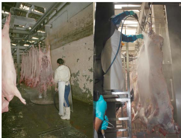
Foto 33. Lavado de canales A) rastro municipal. B) Rastro TIF (Fotos Juana Villada).
