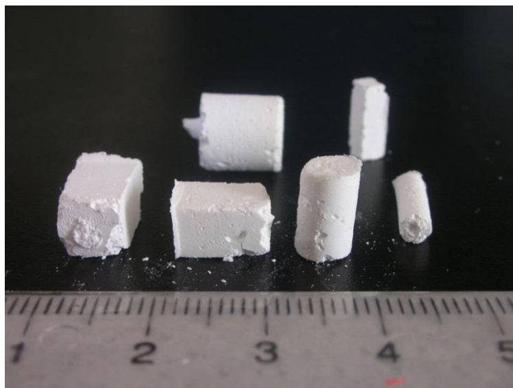
Figura 18: Muestras del material compuesto orgánico-inorgánico base hidroxiapatita obtenidas mediante el proceso Gelcasting modificado. La escala se presenta en cm.
