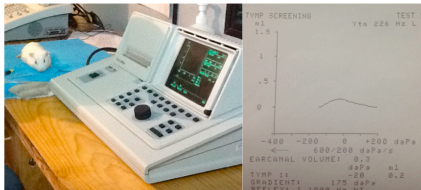
Ilustración 9. Estudio timpanométrico convencional en cobayos. En la gráfica se demuestran los valores de presión y volumen del oído medio y el volumen del conducto auditivo externo.
