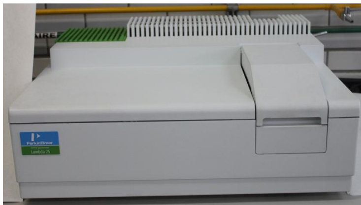
Figura 2.3 Espectrofotómetro Perkin Elmer Lambda 25 para el estudio espectrofotométrico con azul de metileno.
