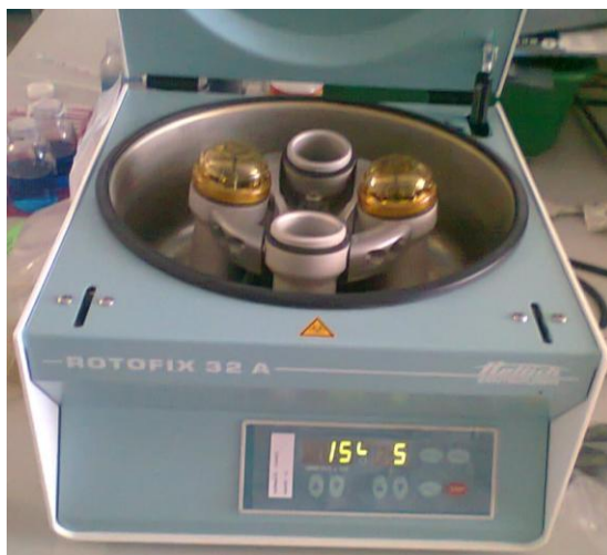
Figura 2.5 Centrífuga Hettich Rotofix 32 A para separar la fase sólida de haloisita de la fase líquida de azul de metileno.
