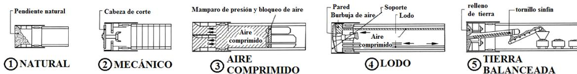
Figura 1.9 Métodos de soporte del terreno y contención de agua en el frente (Maidl *et al*, 2011)
