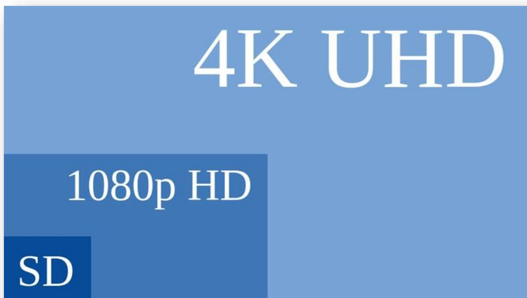
Figura 2.8. Comparativo de la resolución estándar SD (como la del DVD), 1080p Full HD y la nueva 4K UHD.
