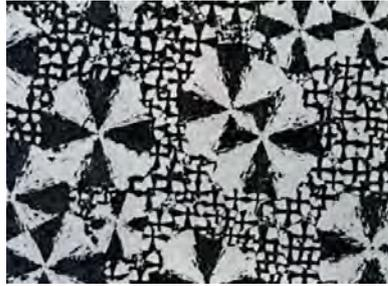
**Fig. 1.4.** Patrón en cruz de Malta de las esferulitas vistas en un microscopio de luz polarizada con prismas de Nicol cruzados en un polímero similar a la silicona. Las esferulitas grandes y pequeñas son el resultado de la cristalización a diferentes temperaturas.
