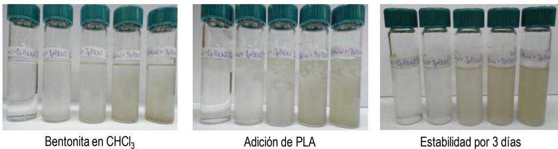
Fig. 4.1. Soluciones PLA-Bentonita preparadas.
