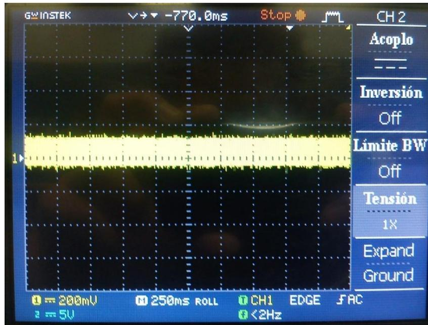
Fig. 5.30. Salida del amplificador sin datos transmitidos
