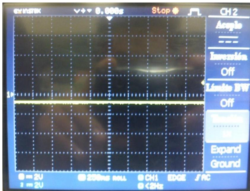
Fig. 5.38. Salida del primer comparador sin transmitir datos
