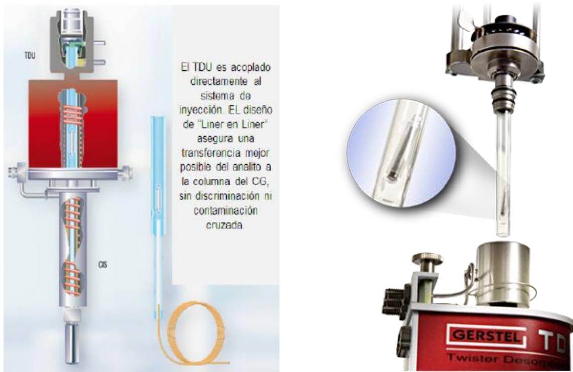
Figura 13. Unidad de Desorción Térmica (TDU) para la SBSE/GERSTEL.
