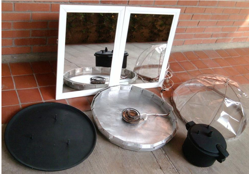
Figura 1.1: Cocedor solar doméstico.
