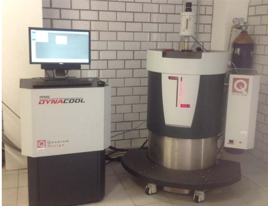
Figura 2.11: Equipo de magnetometría usado en la obtención de la curva de magnetización de blanco y películas de ferrita de cobalto.
