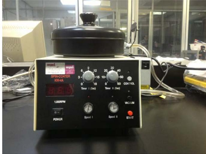
Figura 2.5: Equipo de recubrimiento por giro utilizado para el depósito de películas de ferrita de cobalto.
