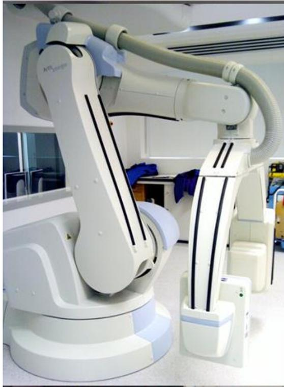
**Figura 3.8** Unidad de fluoroscopia, equipo SIEMENS ARTIS ZEEGO de un arco y un brazo mecánico.
