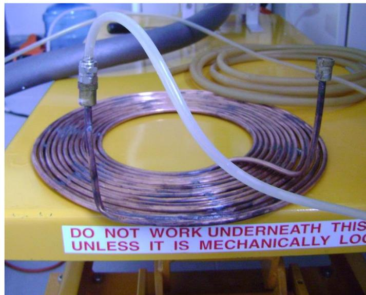
Figura 4.5 *Intercambiador de calor de cobre.*
