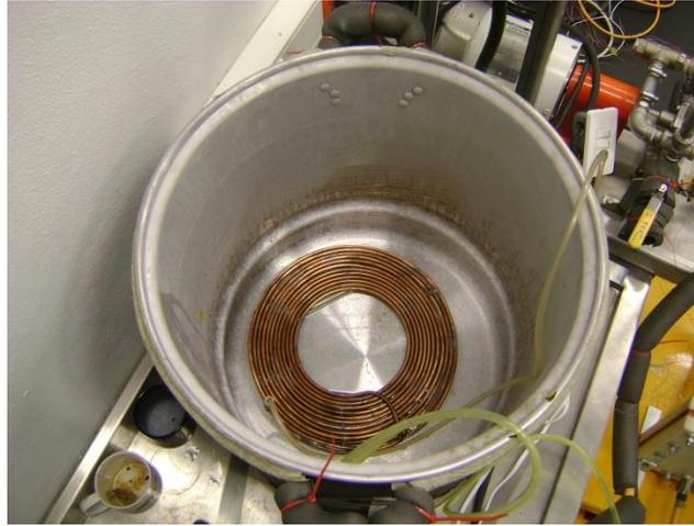
Figura 4.6 *Intercambiador de calor de cobre y tanque de almacenamiento térmico. Calentador*
