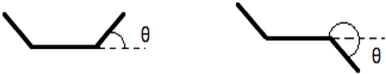
Ilustración 3.4. Esquema simplificado de los isómeros cis (izquierda) y trans (derecha) respecto del eje que define el cuerpo principal de la molécula.
