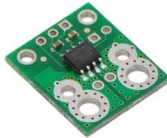
Figura 5.4 Sensor de Corriente ACS714 de Pololu. Imagen del fabricante
