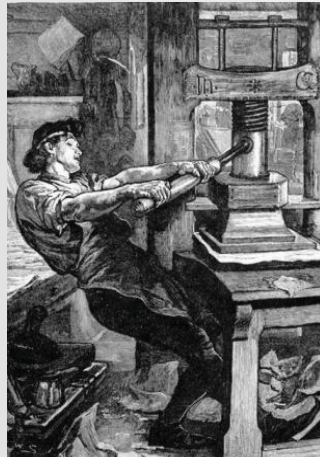
IL11. Grabado de una de las primeras imprentas de Gutenberg utilizada durante el s. XV.
