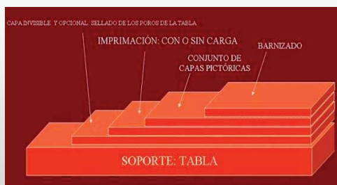
IL9. capas de preparación sobre soporte en madera.
