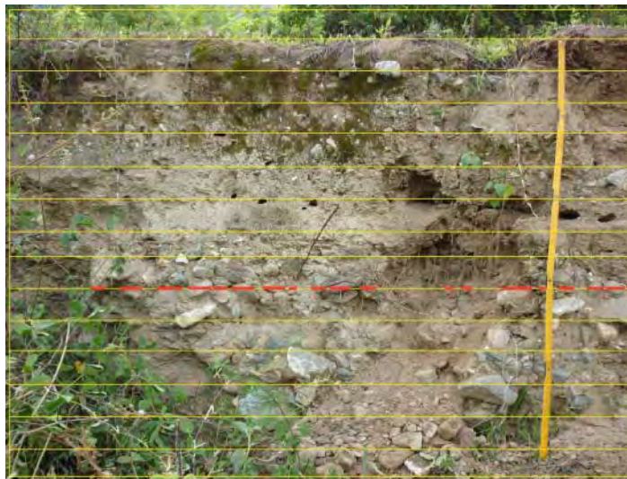
Figura A2. Afloramiento con sobreposición de entramado para medición de intersecciones por el método de Rosiwal. Las líneas rojas, muestran la medición de clastos intersectados por la rejilla.
