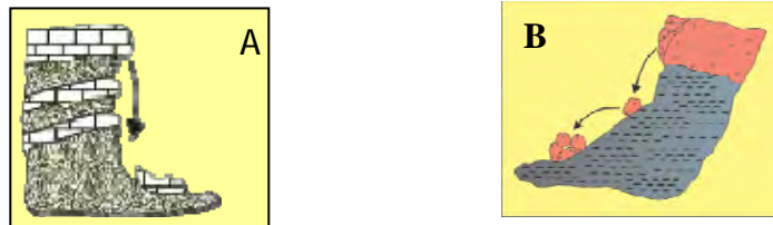
Figura A6a. Caída (desprendimiento) de materiales, A) pendiente \approx 90^\circ Pendiente \approx 45^\circ . (Fuente: Modificada de González de Vallejo et al. , 2002)
