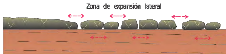
Figura A6e. Expansión lateral de un flujo de lava que sobreyace a un cuerpo de lutitas, existiendo un fuerte contraste en la competencia de cada formación litológica.
