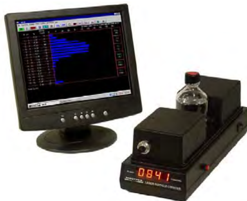
Figura 6. Sistema Laser de conteo de partículas finas Spectrex, modelo PC-2200 más computadora. Tomado de Spectrex (2009).
