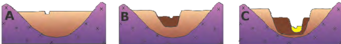
Figura 12. Evolución de las terrazas fluviales en función de las etapas de aluvionamiento e incisión. A) planicie sin terraza; B) planicie con dos fases de aluvionamiento y una terraza; C) planicie con tres fases de aluvionamiento y dos terrazas. (Modificada de Burbank y Anderson, 2001).
