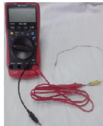
Imagen 6. Conexion de los electrodos en los bornes del multímetro para realizar las valoraciones
