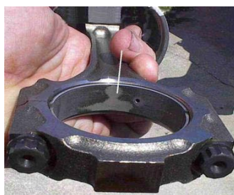
Figura 2.14 Desgaste por fatiga superficial.
