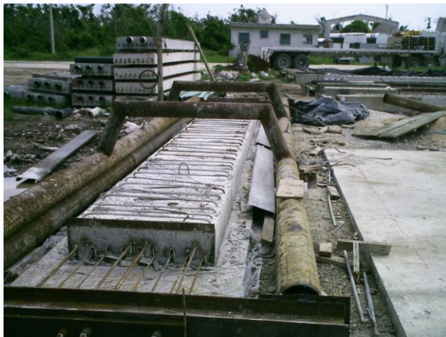
Fotografía No 40 y 41.- Patio de fabricación de losas presforzadas.
