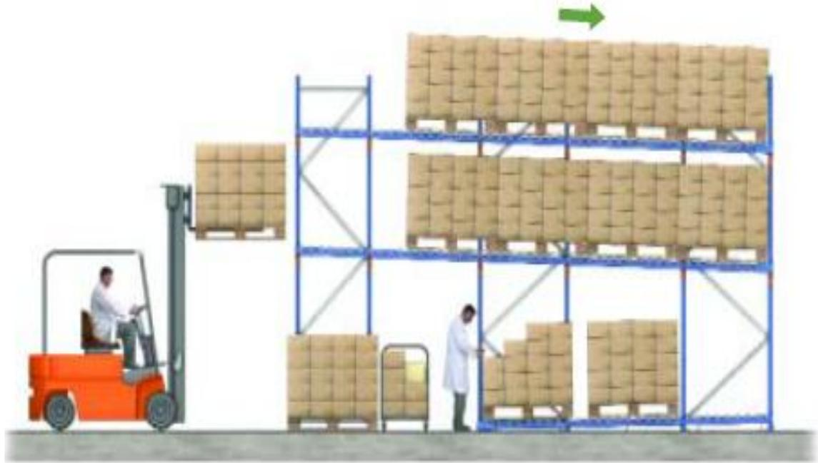
**Figura 13. Rack dinámico (Mecalux, 2009)**
