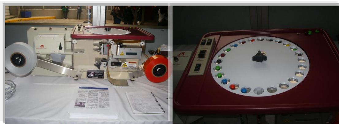
Fig. 5. Máquina reenvasadora de medicamentos orales.
