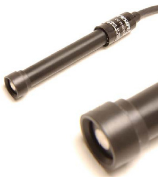
Figura 2.4-5 Fotografía sensor O2 disuelto SENSOREX DO1200
