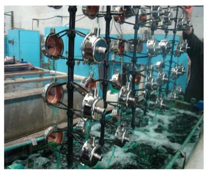
La pieza plástica previamente metalizada o recubierta con el material metálico será conectada a la alimentación eléctrica para que en el proceso de electrodepósito se convierta en el cátodo y tenga carga negativa, en el otro extremo existirá otro electrodo denominado ánodo que será una barra del mismo metal que va a ser depositado y estará cargada positivamente.
