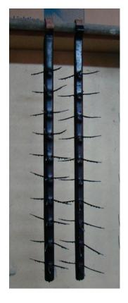
colocadas en racks o rejillas. En estos procesos se pueden recubrir una gran cantidad de piezas de regular tamaño, únicamente limitado por el diseño y capacidad del proceso de electrodepósito utilizado.
