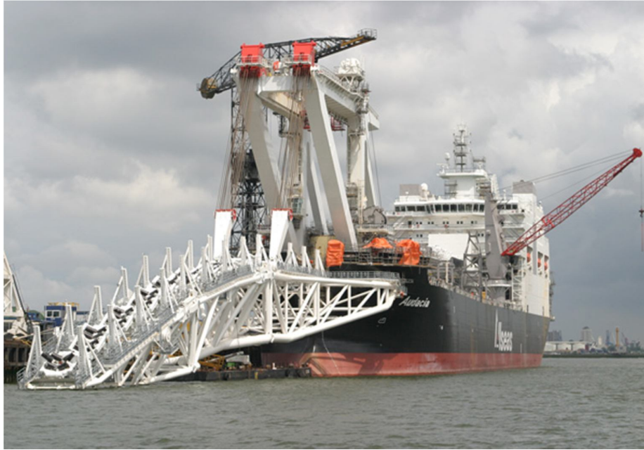
Fig. 3.12 Barcaza tendedora de tubería en lecho marino.
