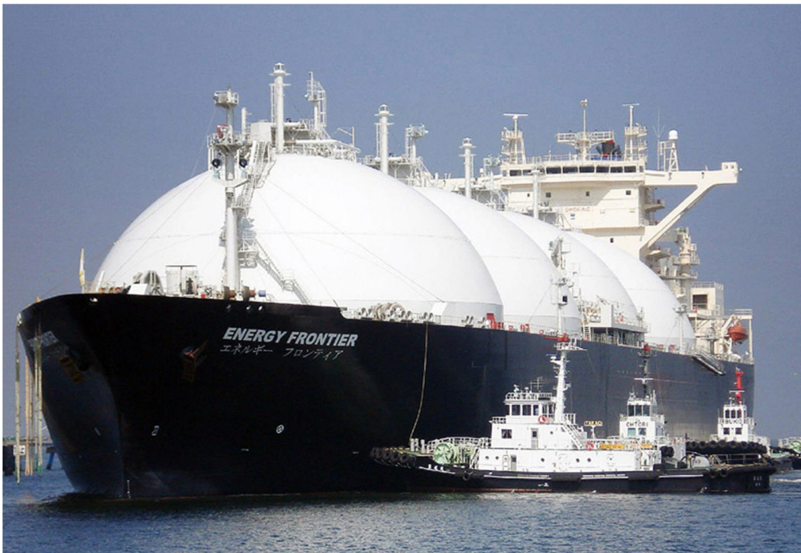
Figura. 4.1 "Energy Frontier" Metanero Japonés de 289 m de largo por 49 m de ancho.
