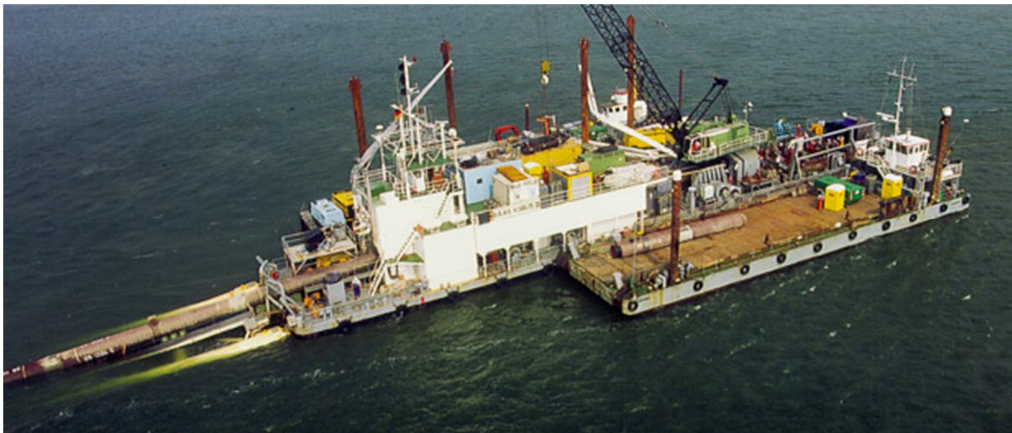
Figura. 3.13 Barcaza tendedora BAAS KOBUS III para aguas poco profundas
