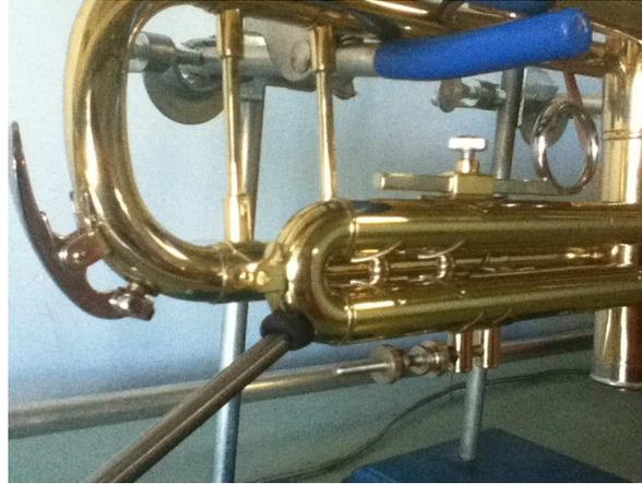
Figura 4.8: Sonda introducida en el hoyo 2 del instrumento.
