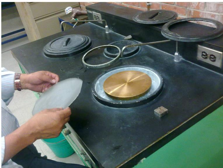
*Figura 3.4. Pulidora Marca Leco, cambio de disco para pulido.*
