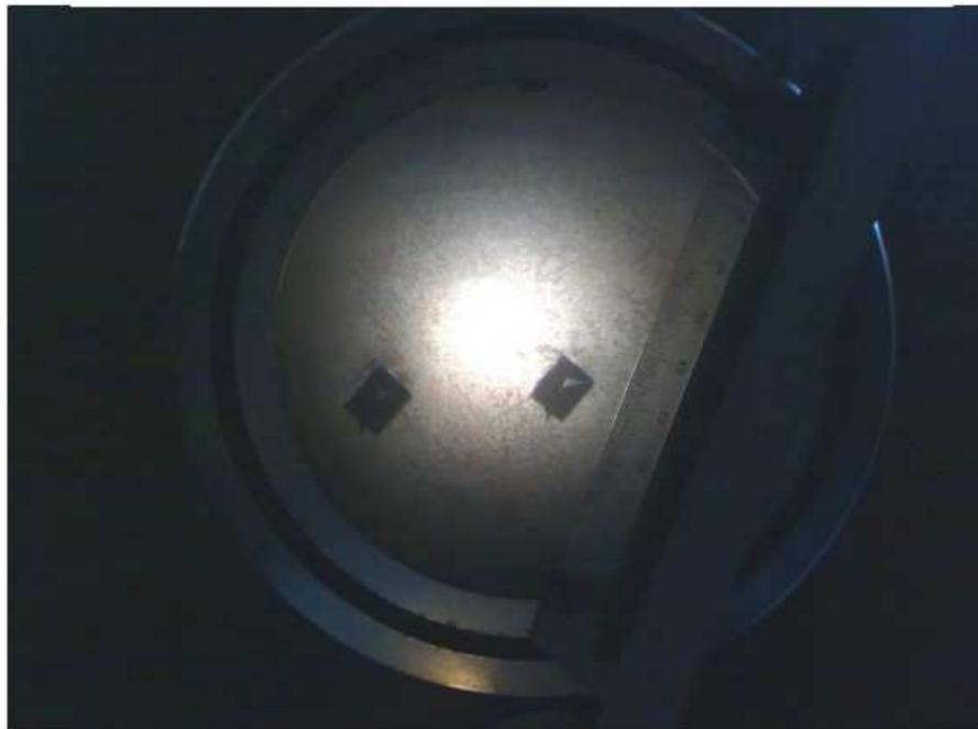
*Figura 3.10. Medición de huellas dejadas por el indentador*
