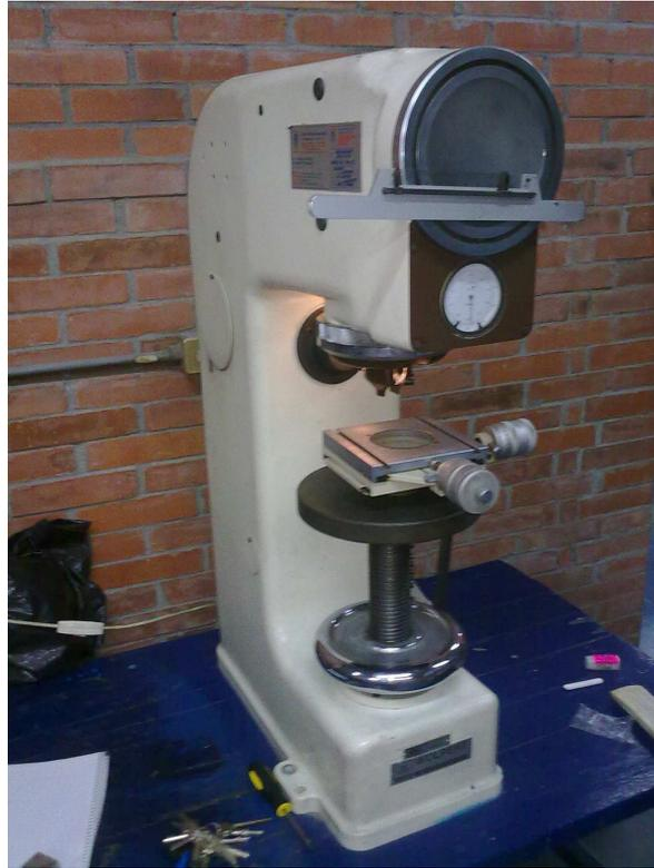
Figura 3.7. Durómetro de la marca Amsler
