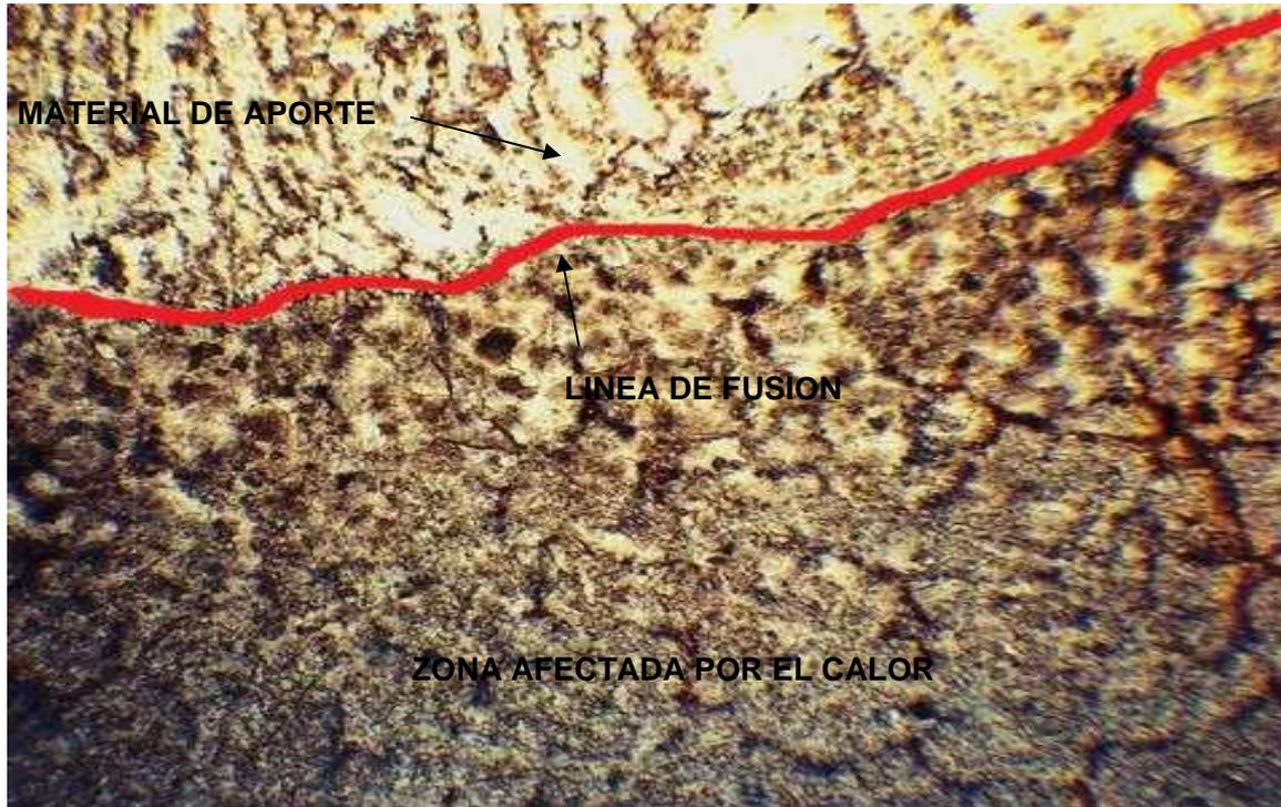
**Figura 7.- Vista general de la ZAC y material de aporte del CA-15 tratado con recocido isotérmico a 700 °C. Tomada a 50X**
