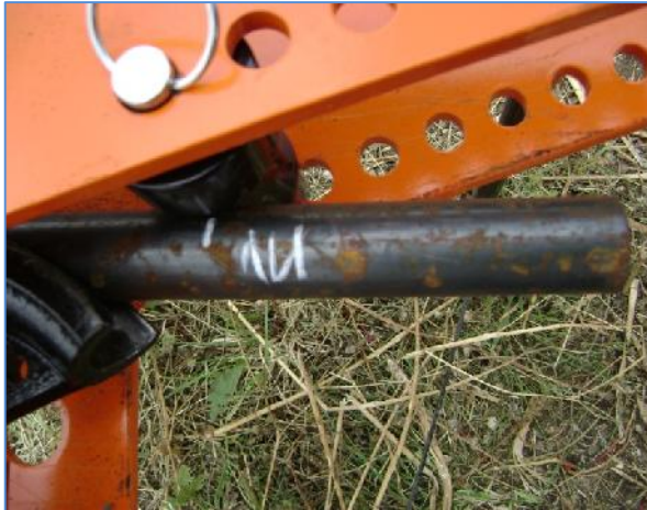
Foto 12: Dobles de las orillas a un ángulo aproximado de 54° y una distancia de 14cm.
