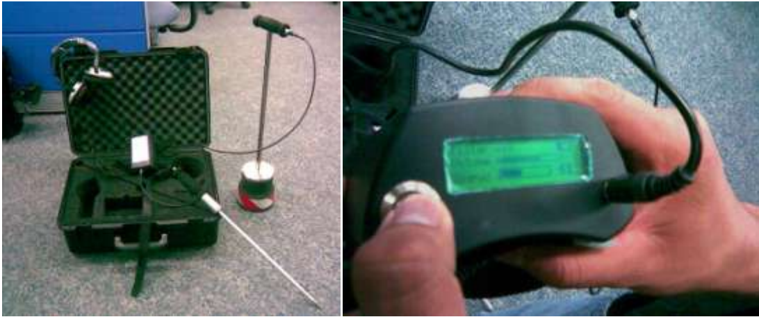
Figura 34. Geófono completo y su unidad (derecha)
