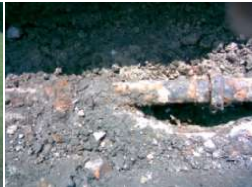
Figura 27. Fugas por picadura de tubo de acero galvanizado durante 2008. Facultad de Derecho (a), Biblioteca Central (b), Facultad de Odontología (c) y Torre de Humanidades (d) (Zona Central)
