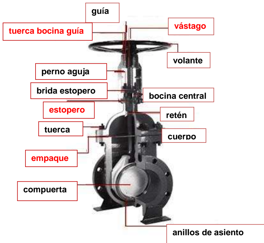
Figura 5. Partes de una válvula y puntos de falla típicos (rojo)
