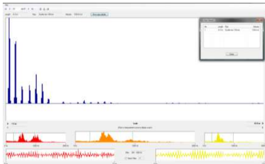
Figura 44. Imagen de la correlación SS-C19, marcando una fuga fuera de rango (números negativos)
