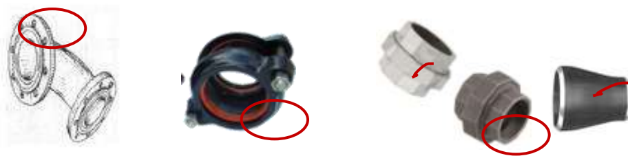
Figura 4. Puntos de falla típicos en accesorios (puntos de unión)
