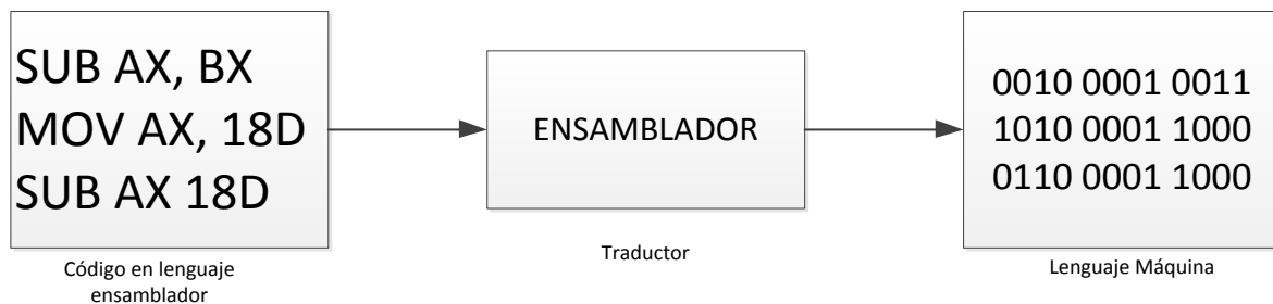
Figura 10. Proceso de conversión entre lenguajes que realiza un ensamblador.
