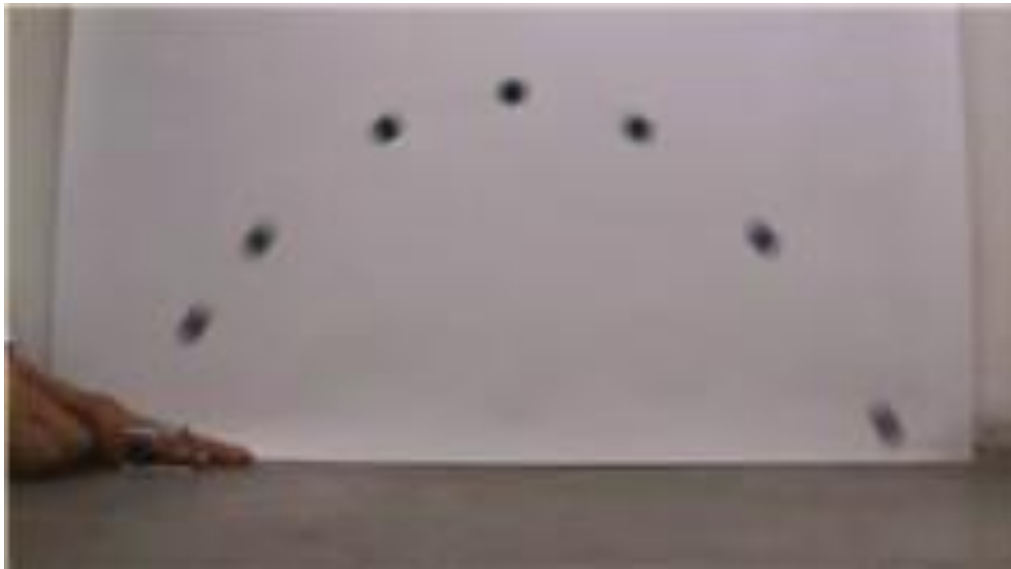
FIGURA 2. RECORRIDO DE UNA CANICA DESPUÉS DE SER LANZADA POR UNA CATAPULTA.
