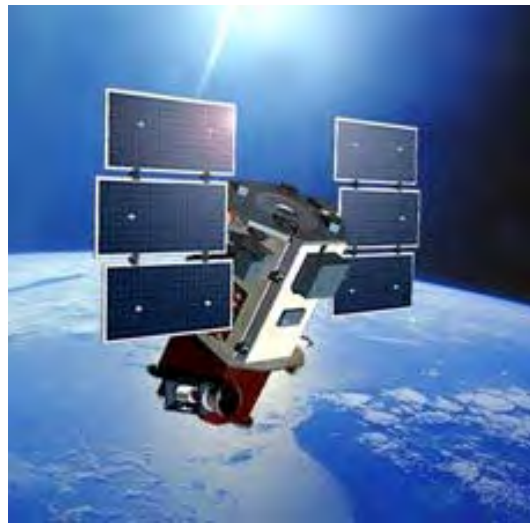
Figura 2.16. El satélite de alta resolución QuickBird en órbita heliosincrónica. http://www.digitalglobe.com/downloads/QuickBird-DS-QB-Web.pdf
