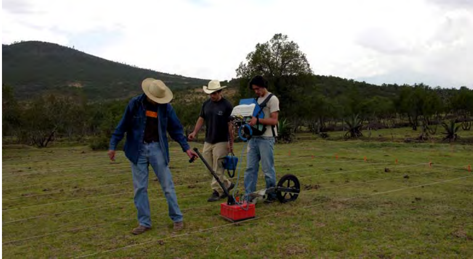
Figura 7.39. Recolección de datos con georradar en las retículas G53 y G54.
