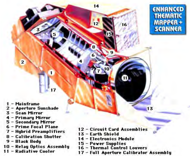
Figura 2.14. Componentes principales del sensor ETM+ de la serie Landsat 7. http://landsathandbook.gsfc.nasa.gov/payload/
