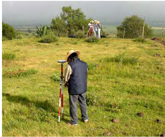
Figura 7.14. Levantamiento con GPS en modo cinemático.
