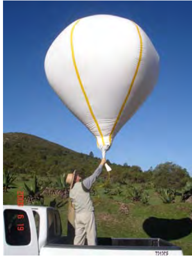
Figura 7.5. Globo inflado con helio utilizado para la fotografía aérea con globo cautivo.
