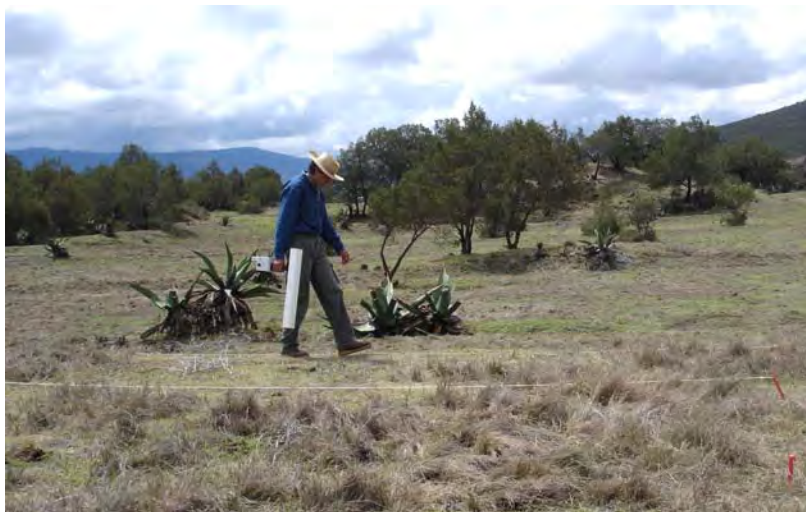
Figura 7.7. Adquisición de datos magnéticos sobre el conjunto central del sitio.
